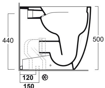
Curva tecnica per lo scarico a pavimento regolabile da 12 a 15 cm
