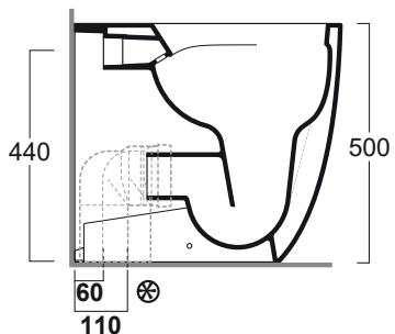
Curva tecnica per lo scarico a pavimento regolabile da 6 a 11 cm
