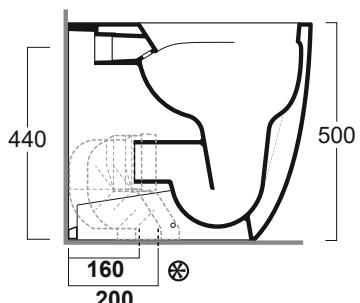
Curva tecnica per lo scarico a pavimento regolabile da 16 a 20 cm
